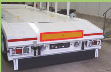
Rimorchio con luci posteriori protette, luci lampeggianti a LED di colore blu, luci di lavoro. Trailer with protected rear lights, blue LED flashing lights, work lights.
