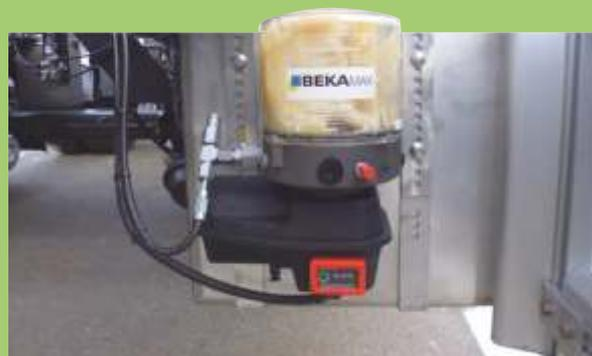
I sistemi di lubrificazione automatica sollevano il conducente dall'obbligo di lubrificare regolarmente i cuscinetti.
