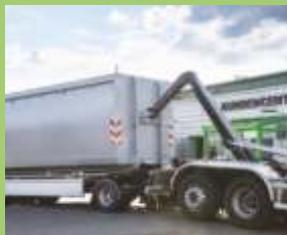
**Standard:** I rimorchi per il trasporto di container devono essere abbassati durante la procedura di carico. Questo avviene automaticamente quando si sganciano i tubi dell'aria o, in alternativa, quando si apre il bloccaggio.
